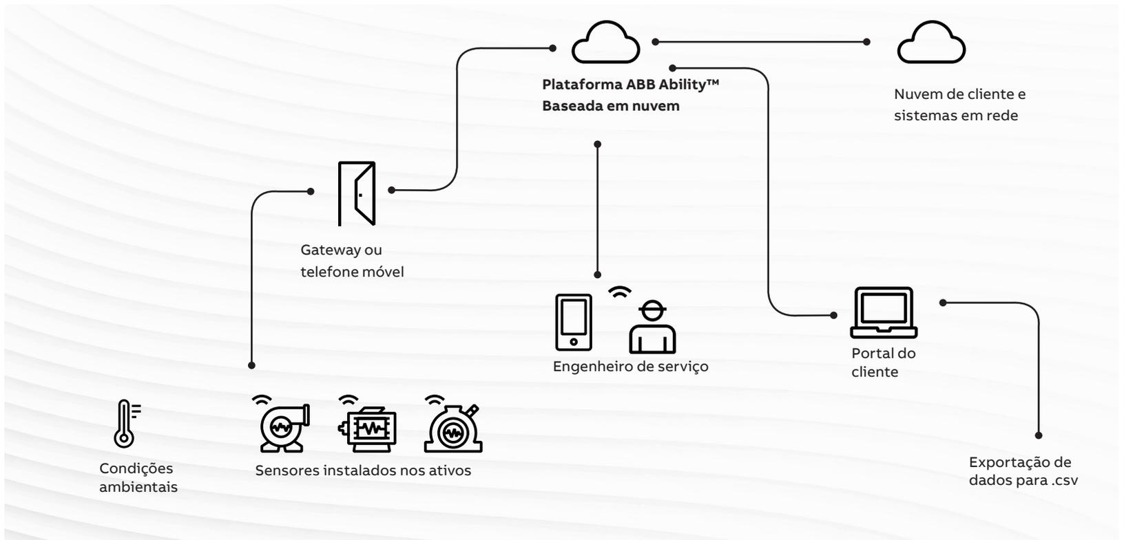
— 01 Solução de monitoramento de condições da ABB para motores de baixa tensão: O ABB Ability™ Smart Sensor transmite dados por meio de um smartphone ou gateway para um serviço de nuvem seguro. Os algoritmos analisam os dados e os convertem em informações significativas, que são enviadas ao smartphone e ao portal do cliente do usuário.
